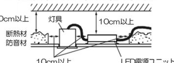
電気配線は断熱材・防音材の上側にくるように配線してください。（器具本体に電源線を接触させないでください。）
