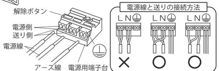
**警告** 端子台に差し込むケーブルは、必ずWFΦ1.6またはΦ2.0の単線ケーブルで真っ直ぐな線を使用してください。
